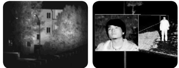
links: 3 Stockwerke in 200 m Entfernung. Das Störlicht durch die Straßenbeleuchtung wird unterdrückt. rechts: Observation einer Person in 150 m Entfernung.
