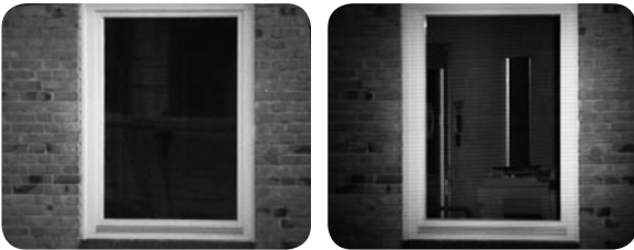
links: Observation aus 40 m Entfernung ohne Laser. rechts: Observation aus 40 m Entfernung mit Laser – das Rauminnere ist sichtbar.
