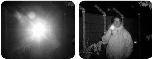
links: Übersteuerung des Sensors ohne Laser. rechts: kontrastreiches, vom Störlicht entkoppeltes Videobild.
