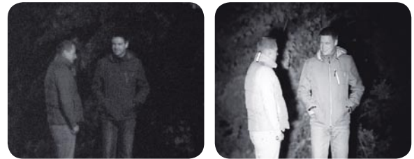
Observation aus 80 m Entfernung ohne Aufmerksamkeit zu erregen (links: ohne Laser, rechts: mit Laser).
